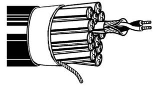
Blaues, hochflexibles Multicore-Kabel, 12 x 2 x 0,22 mm<sup>2</sup>, paarweise isoliert mit Wendelschirm und Beilaufzitze, mit PVC/Gummi-Mantel und einem Aussendurchmesser von 18,7 mm.
