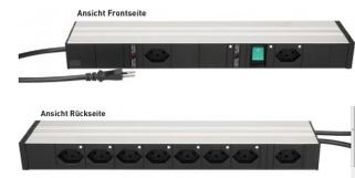
**Die Multimedia PDU ist mit 10 Steckdosen Typ 13 bestückt. Frontseitig ist eine Dauerstromsteckdose und eine geschaltete Steckdose Typ13 verfügbar. Auf der Rückseite befinden sich 8 geschaltete Steckdosen und eine Dauerstromsteckdose. Und das alles im Format 19Zoll, 1HE**
